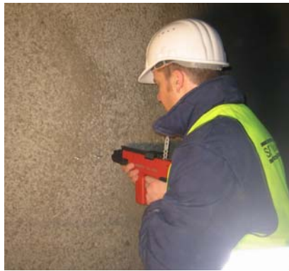
Bild 2: Frühfestigkeitsbestimmung mittels a) Bolzensetzgerät und b) Auszugsgerät
