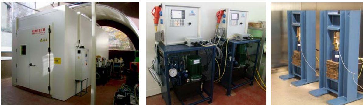
Bild 9: a) Klimasimulations-Zelle mit b) Hydraulikaggregaten und c) Langzeitversuchsständen
