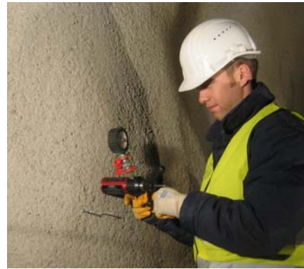
Bild 2: Frühfestigkeitsbestimmung mittels a) Bolzensetzgerät und b) Auszugsgerät
