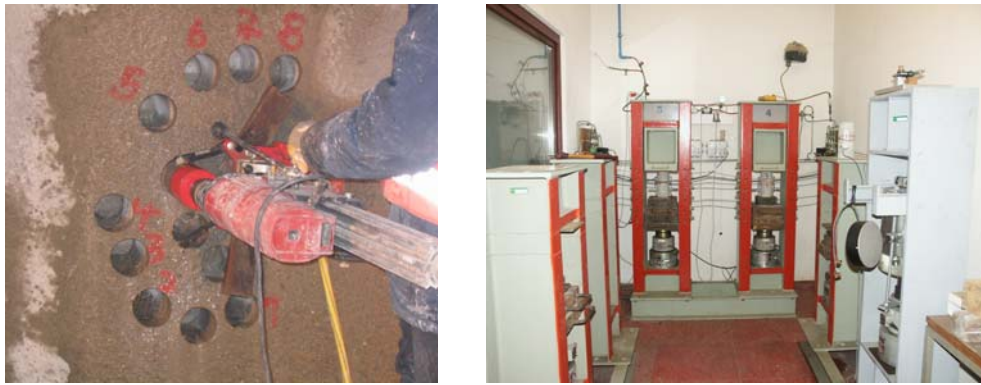
Bild 6: a) Bohrkernentnahme und b) Langzeitversuchsstände
