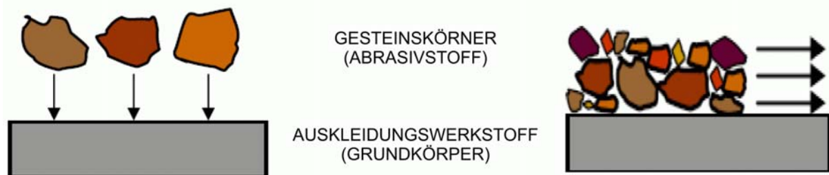
Bild 14: Beanspruchungsarten des Auskleidungswerkstoffes
