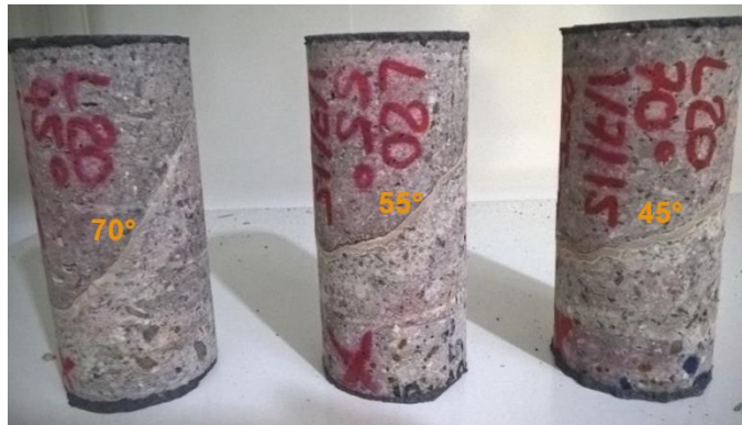
Bild 5: Bohrkerne mit unterschiedlicher Orientierung der Spritzabdichtung
