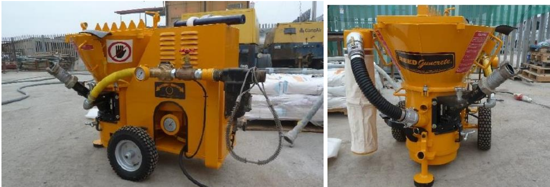
Bild 14: Reed „SOVA“, Trockenspritzeinheit mit Staubfilter
