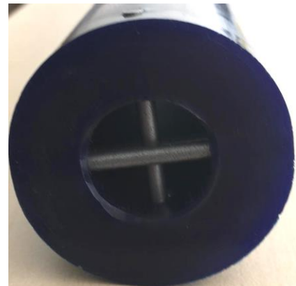
Bild 16: Düse mit Kreuz zur Verbesserung des Spritzbildes
