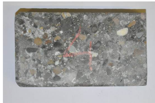
Bild 7b: Keine sichtbaren Schäden am neuentwickelten Spritzbeton nach ca. 11 Monaten Lagerung bei 5°C in 15.000 mg/l SO 4 2- . Probekörpergröße ca. 5 x 3 x 10 cm.
