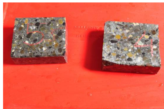
Bild 9: Die neuentwickelte Spritzbetonrezeptur weist auch nach 30 Monaten bei 5°C in 15.000 mg/l SO 4 2- keine erkennbaren Schäden auf.
