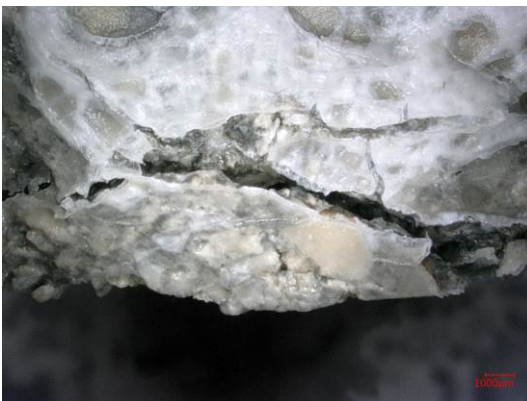
Bild 7c: Detailaufnahme unter dem Lichtmikroskop zeigt sichtbare Rissbildungen an der Referenz Spritzbetonprobe nach 11 Monaten. Weiße Flächen: Calciumcarbonat.
