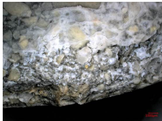
Bild 7d: Auflösung des Zementsteins und Bildung von Thaumasil (hellweiße Bereiche) an der Referenz Spritzbetonprobe nach ca. 11 Monaten Einlagerung.
