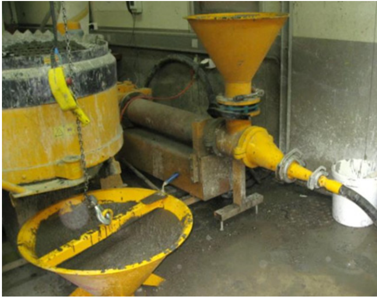
Bild 3: Laborzwangsmischer (links), Einzylinderpumpe mit Befüllvorrichtung (rechts).
