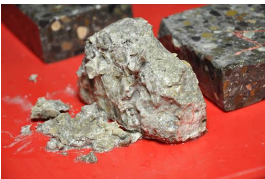
Bild 8: Nach 30 monatiger Einlagerung bei 5°C in 15.000 mg/l SO 4 2- zeigt die Referenz Spritzbetonprobe massive Auflösungserscheinungen.
