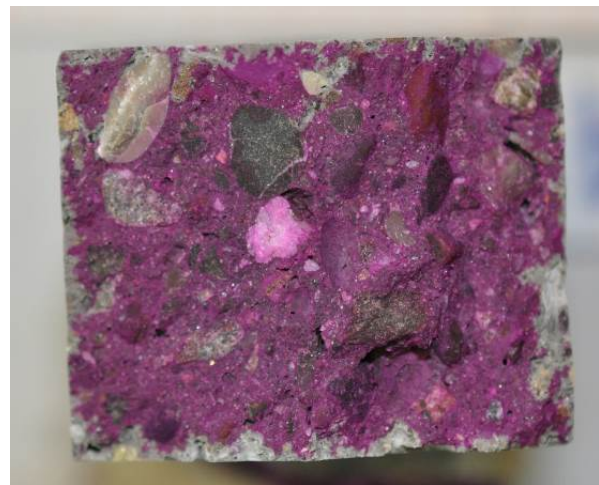
Bild 6: Karbonatisierung am neuentwickelten Spritzbeton nach 103 Tagen. Probekörpergröße ca. 3 x 4 cm.
