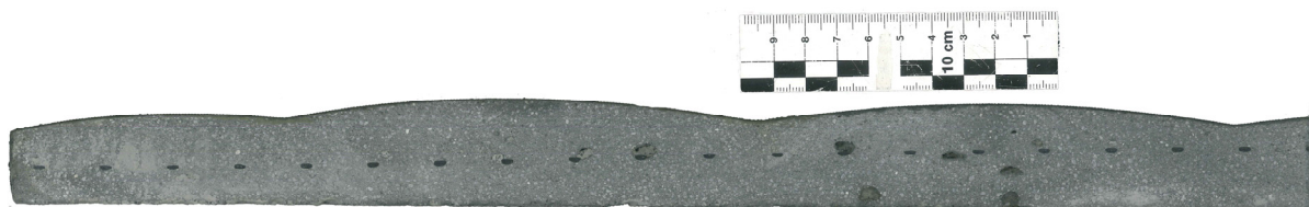
Bild 10: Sägeschnitt eines Zugprobekörpers aus Spritzbeton für das Projekt NEST HiLo mit Lageabweichung der Bewehrung (Foto: Jan Bielak)
