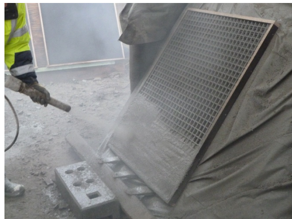
Bild 4: Herstellung von bewehrten Probekörpern in Durchspritztechnik (Foto: Martin Herbrand)
