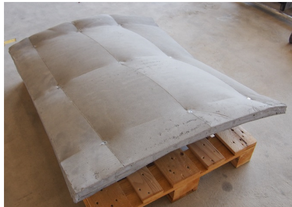
Bild 6: Abdrücke der innovativen Seilnetzschalung auf der Schalenunterseite (Foto: Jan Bielak)
