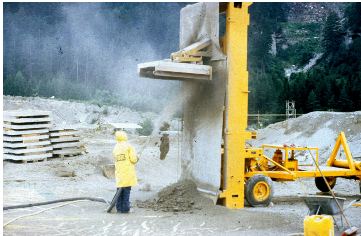
Bild 3: Zu geringe Festigkeitsentwicklung beim Auftrag über Kopf in der Versuchseinrichtung
