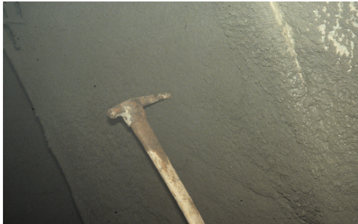
Bild 1: Bergeisen zur intuitiven Kontrolle ausreichender Frühfestigkeit
