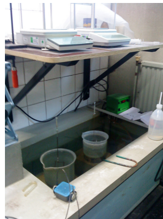
Bild 8: Labormessplatz für US-Laufzeit und chem. Schrumpfvolumen
