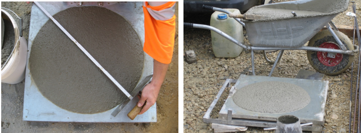
Bild 1: Ausbreitmaß der Mischungen 6 (links) und 6a (rechts)
