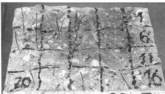
Bild 8: Stahlfaserverteilung mit der Faserdosierung von 20 kg/m 3 im Versagensquerschnitt nach RILEM Versuch
