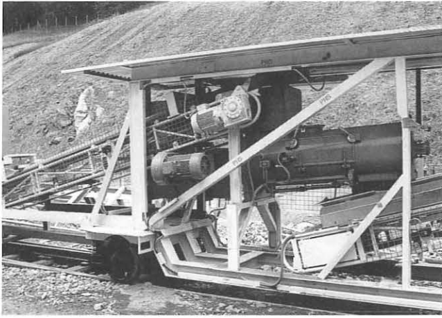
Bild 5: Der Pflugscharmischer wird oben mit Zuschlag und Bindemittel beschickt; unten wird das Trokenmischgut abgezogen
