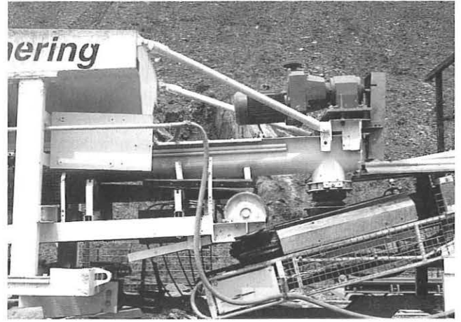
Bild 6: Übergabe von Zuschlag unten und Bindemittel oben vom Bindemittelwagen auf den Mischer
