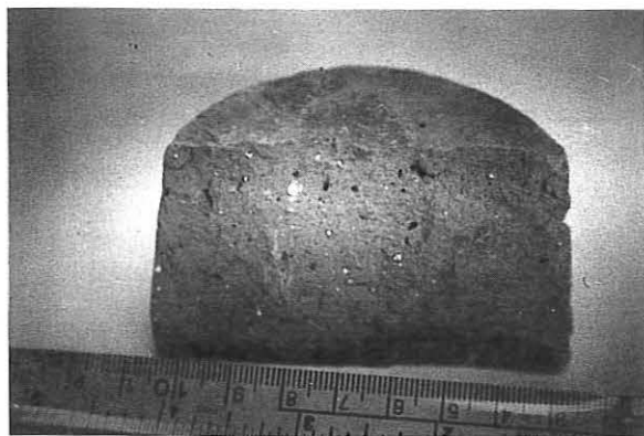
Bild 7a: Probe mit ungelösten Partikeln Pulver-BE
