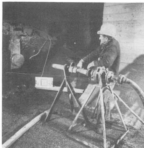
Abb. 14. Einrichtung zur Messung der Aufprallenergie.
