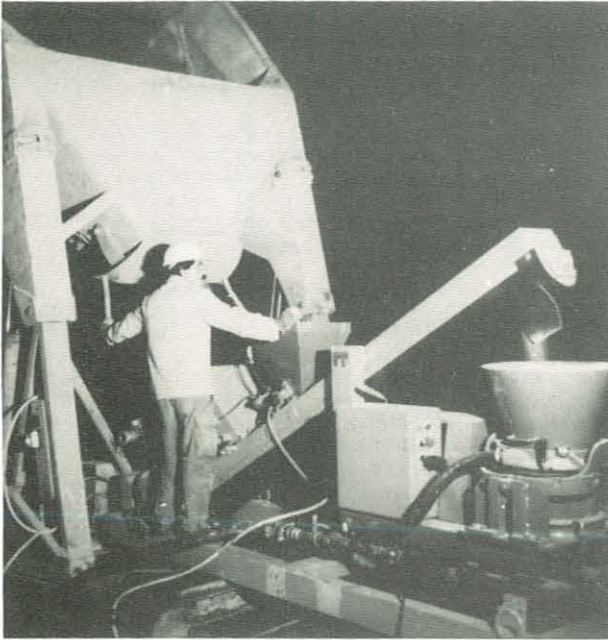
Abb.21. Dosierschnecke für Grobkorn; Zweiwegverfahren.
