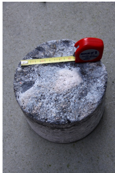
Bild 5: Dem Gebirge zugewandte Grenzfläche des Bohrkerns
